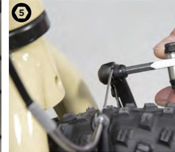
Lösen sie die Zugklemmschraube und ziehen sie mit der Hand am Zug. Sobald sich die Beläge dicht an der Felge befinden (ohne sie zu berühren), schließen sie die Zugklemmschraube wieder.
