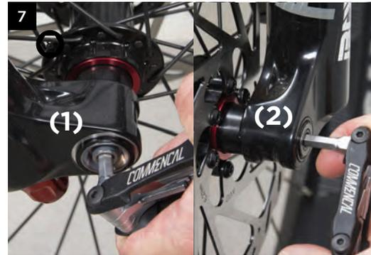
2) Schrauben sie zuerst die Achse ein (1). Ziehen sie dann die Konter-schraube auf der Brems-seite an (2).
