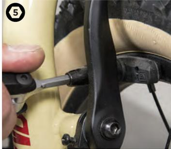
Lösen sie den Bremsbelag mit einem 5 mm Inbusschlüssel und richten sie ihn auf der Bremsflanke der Felge aus. Halten sie den Belag in Position und ziehen sie die Schraube wieder an. Wiederholen sie den Vorgang auf der Gegenseite.
