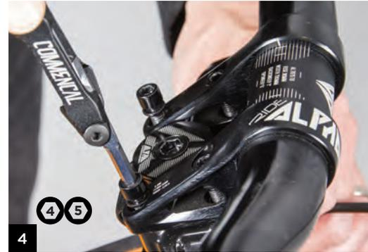
2) Montieren sie den Vorbau auf der oberen Gabelbrücke und richten sie den Lenker mit Hilfe der lasergravierten Markierungen aus.
