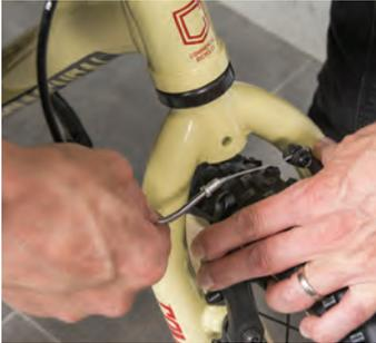
Lösen sie den Bremszug aus dem Zuganschlag, wie auf dem Foto abgebildet. Falls sie Schwierigkeiten damit haben, reduzieren sie die Zugspannung am Bremshebel oder lösen sie die Zugklemmschraube.
