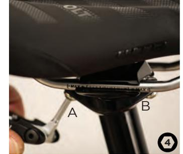
Es importante montar correctamente su sillín para su comodidad y para su salud. De hecho, un mal ajuste podría causar dolor al usar su bicicleta. Para ajustar la posición de su sillín, afloje los dos tornillos A y B. Ajuste de acuerdo a sus preferencias. Apriete los tornillos de forma que su sillín quede horizontal.
