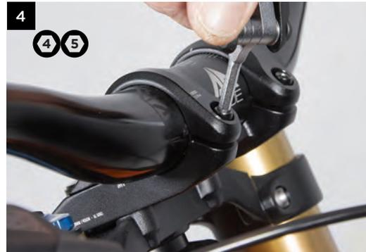
2) Colocar la tapa de la potencia en el manillar y atornillar toda la parte inferior de la potencia (sin apretar), y centrar el manillar gracias a su gravado.
