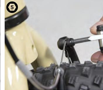
Afloje el tornillo que sujeta el cable. Apriete con la mano el cable para que las zapatas estén casi en contacto con la llanta (aproximadamente 1 mm). Aprieta el tornillo.
