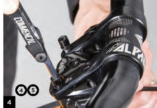
2) Instale la potencia en la pletina. Centre el manillar usando el gravado.
