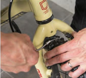
Desconecte el cable de freno como se muestra en la imagen. Si tiene dificultad, puede desenroscar el tornillo que sujeta el cable o aflojar el tensor de la palanca de freno unas pocas vueltas.
