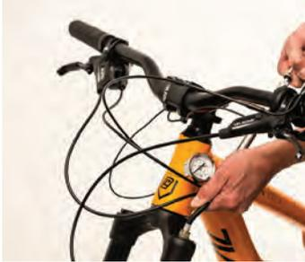
Es muy importante ajustar las suspensiones acorde a su peso. Para ello, infle sus suspensiones usando la bomba de alta presión. Para encontrar la presión correcta, consulte el manual del fabricante
