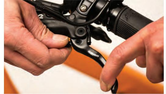
Puede ajustar la distancia de sus manetas de freno. Para hacer esto, gire el tornillo de ajuste.
