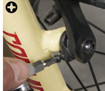
Reconecte el cable de freno y afloje el tornillo de ajuste unas vueltas.
