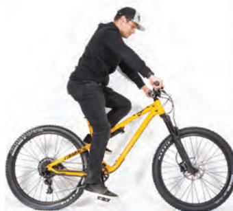
Para saber la altura correcta, suba a su bicicleta. Pon un pedal, el izquierdo o el derecho, abajo. Debes tener tu pierna semi-estirada como en la imagen.
