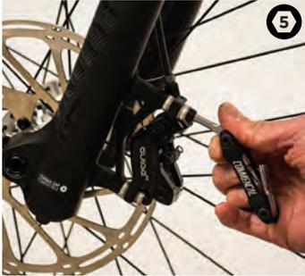
Para alinear la pinza con el disco, primero afloje los dos tornillos media vuelta para que la pinza se mueva. Gire la rueda y accione el freno correspondiente.
