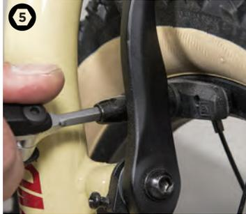
Con una llave Allen de 5 mm, afloje una zapata y colóquela contra la pista de frenado de la llanta. Oriéntela como en la imagen y mientras la mantiene presionada, apriete el tornillo. Haz lo mismo para la otra.
