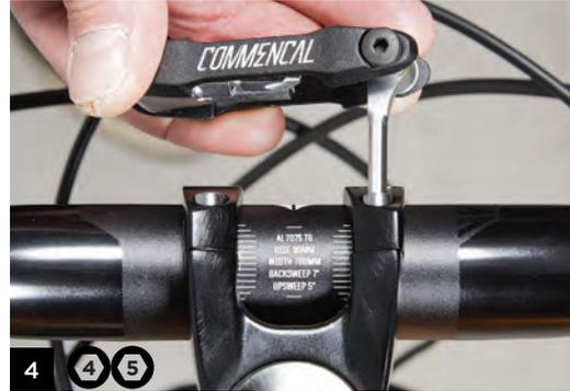
2) Monte y centre el manillar usando el gravado laser (puede también ajustar la inclinación).
