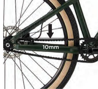
Para bicicletas de una marcha, verifique que su cadena está lo suficientemente tensa. Su cadena debe tener un juego vertical de aproximadamente 1 cm a una distancia media entre el eje de la rueda y el eje pedalier.
