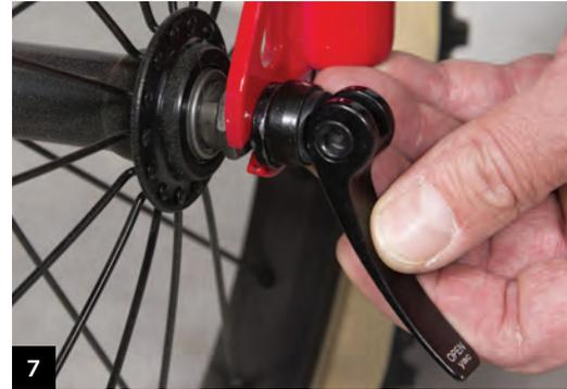
2) Mettez l'axe rapide (en position ouverte) dans le moyeu. N'oubliez pas les rondelles de sécurité si elles sont livrées avec.
