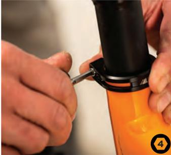
Pour régler la hauteur de votre selle, desserrez votre collier de selle (soit à la main soit à l'aide d'une clé allen de 4mm), ajustez la hauteur et resserrez le collier.
