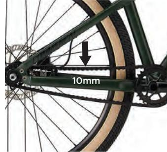
Pour les vélos mono vitesse, vérifiez que votre chaîne est assez tendue. Votre chaîne doit avoir un jeu vertical de 1cm environ à mi-distance entre l'axe de la roue et l'axe du pédalier. Si ce n'est pas le cas, retendez-la, soit en reculant votre roue, soit à l'aide du système de tension de chaîne.
