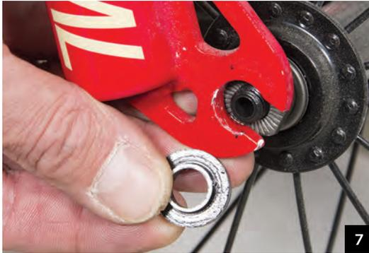
3) Rabattez le levier à mi-chemin entre la position ouverte et fermée et serrez l'écrou de réglage qui est du côté opposé au levier, à la main.
