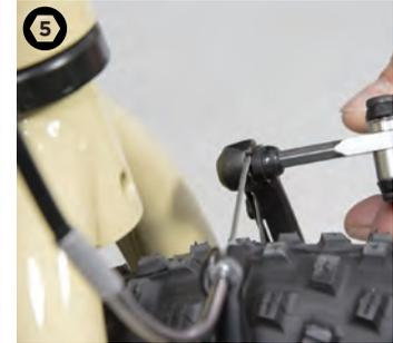
Desserrez la vis qui tient votre câble. Tendez à la main votre câble de manière à ce que les patins soient presque en contact avec la roue (à environ 1mm). Resserrez la vis.
