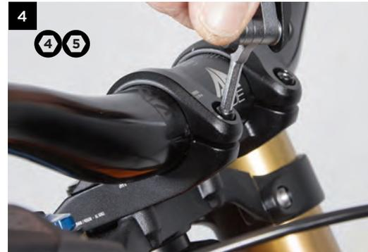
2) Mettez en place le reste de la potence sur le cintre et vissez le tout sur la partie inférieure de la potence (sans serrer), et en centrant votre cintre grâce au marquage.
