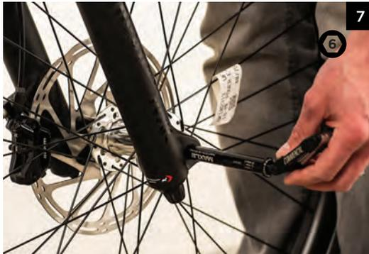
2) Installez la roue avant dans la fourche. Installez l'axe et serrez-le.
